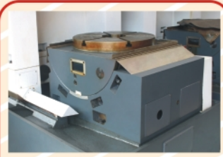
YKD5150型工作台可倾斜角度调整范围 \pm 10^\circ
